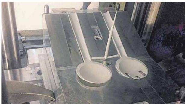
Produktion bei der Hamburger Firma Hansemold: Das Besteck entsteht im Spritzguss-Verfahren.
